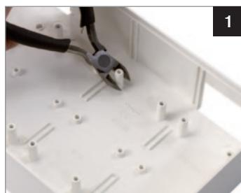
Удалить выступающие элементы крепления розеточного модуля
