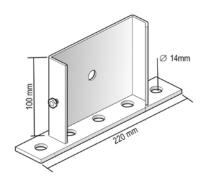
Для крепления кабельного лотка лестничного типа вертикально полу Фиксируется на лонжероне
