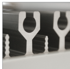
Корпус - радиатор из алюминиевого профиля
