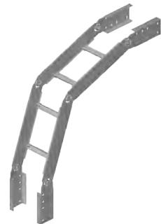
Возможность изготовления дуги любого внутреннего радиуса, в соответствии с минимальным радиусом изгиба кабелей. Для соединения фасонного элемента с кабельростом следует использовать соединитель фасонных элементов LSSU... и болты SGKМ8х16.
